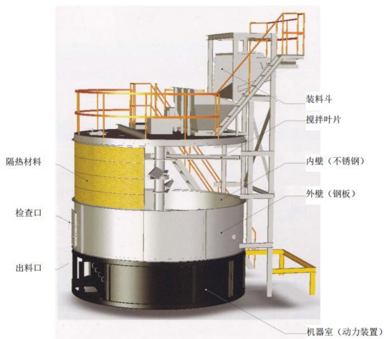
图6.2-1 立式发酵罐构造图
